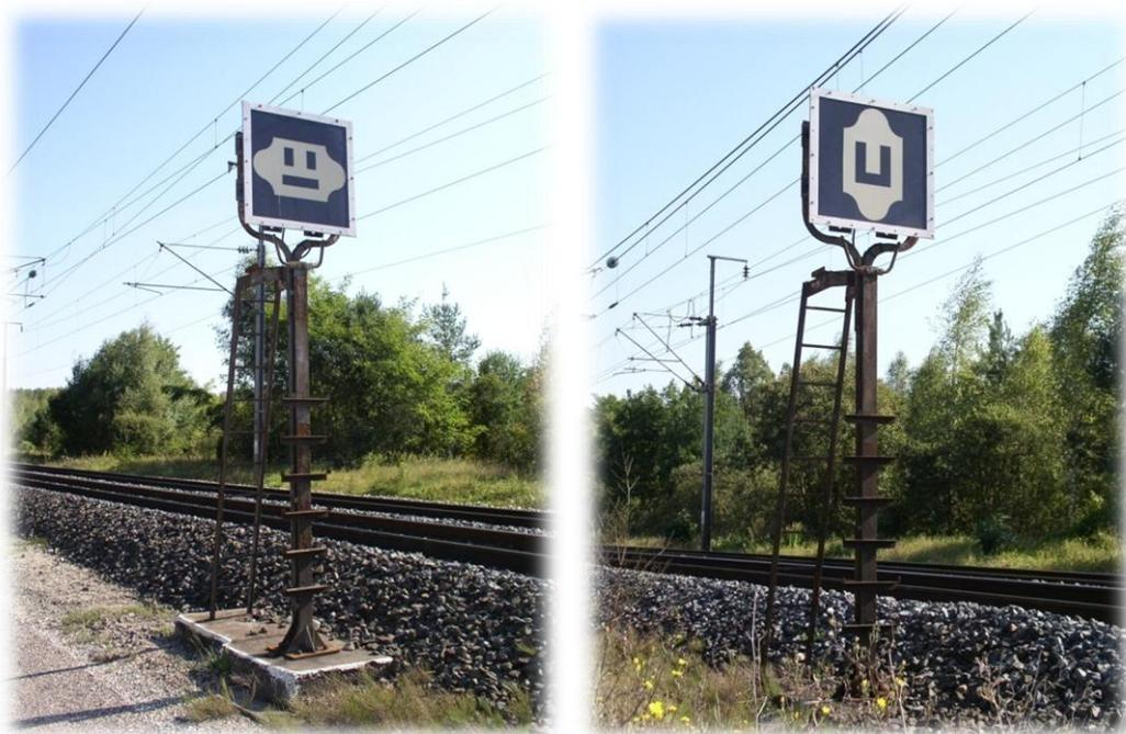
*Fig. 25 : Signal d'exécution « Coupez courant » et signal « Fin de parcours »*
